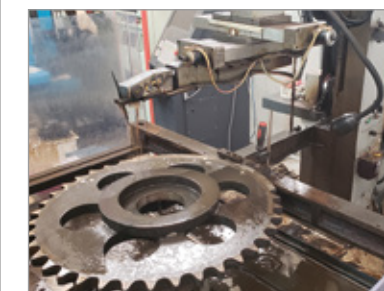
Рез звездочки цепной передачи на станке М 800
