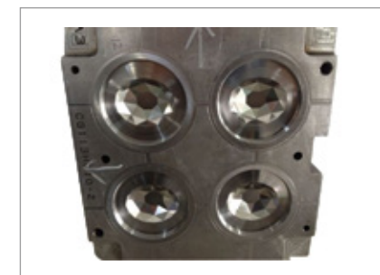
Пресс-форма с шероховатостью Ra0,2.
