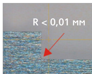
Минимальный радиус в углах менее 0,01 мм.
