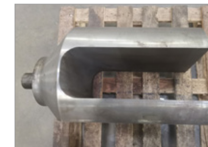
Рез детали-проушина на станке М 550. Сталь 35. Габариты: 450 x 150 x 360 мм
