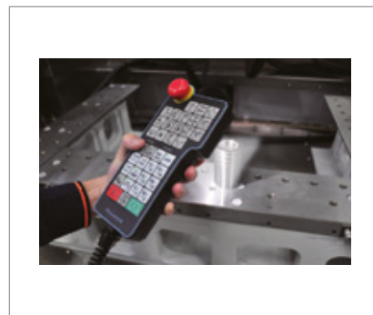
Новый пульт управления с дополнительным освещением.
