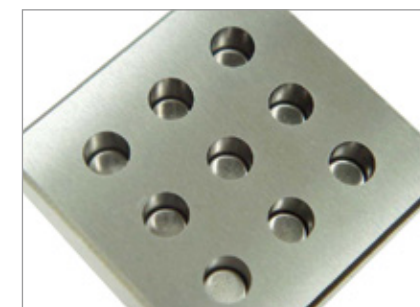
Прожиг матрицы отверстий диаметром 10 мм, глубина 10 мм, шероховатость Ra0,15.
