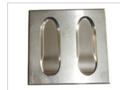
Изготовление пресс-формы подошвы с шероховатостью Ra0,2.
